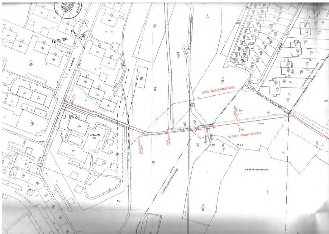
33/Výkres rekonstrukce vodovodního řádu.
